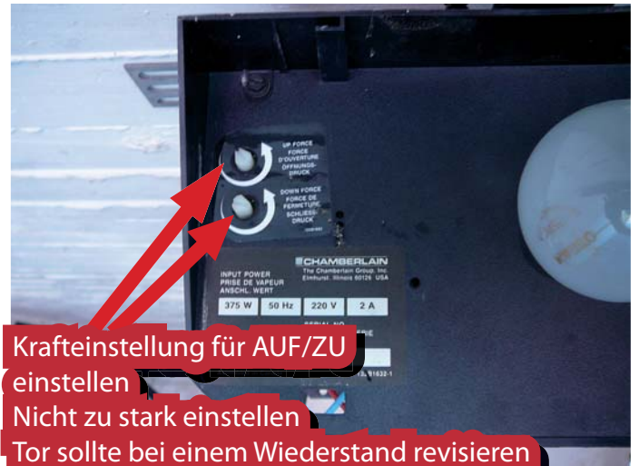
Abdeckung befestigen Antrieb mit Tor verbinden Feineinstellung für Fahrtweg AUF/ZU
